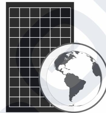
Pro dosažení co nejvyššího energetického výnosu je třeba najít nevhodnější místo pro umístění panelů. Na severní polokouli nakloňte panely jižním směrem a na jižní polokouli je nakloňte na sever. O optimálním úhlu naklonění modulu se poradte s místním dodavatelem fotovoltaického zařízení.
