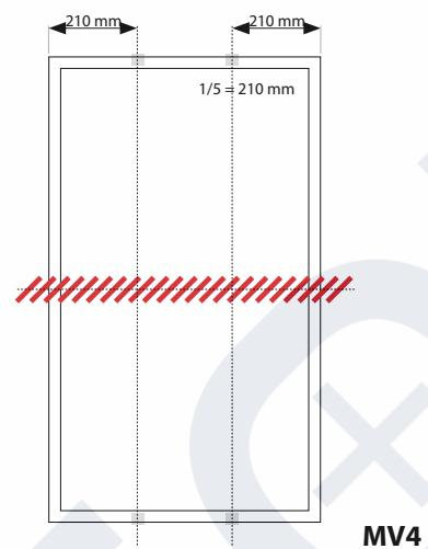
Věnujte prosím pozornost specifikaci přípustného statického zatížení a rozsahu upnutí na následující straně. Uvedené varianty instalace platí pro instalaci na výšku i na šířku. Ve středové oblasti panelu (šrafovaná oblast) nesmí být instalován žádný instalacní systém.
