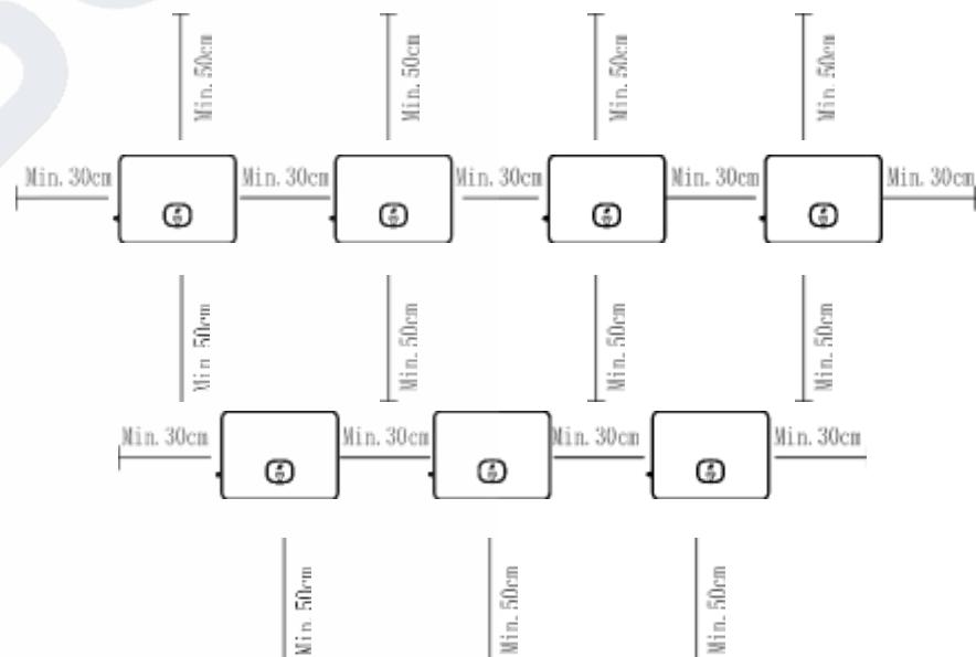
Obr. 5.3 Požadavky na volný prostor pro více střídačů
